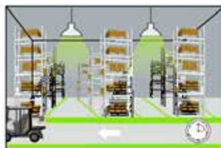
3. Luego de un periodo de espera, la luminaria se atenuará si ya no es detectada una señal de movimiento.
